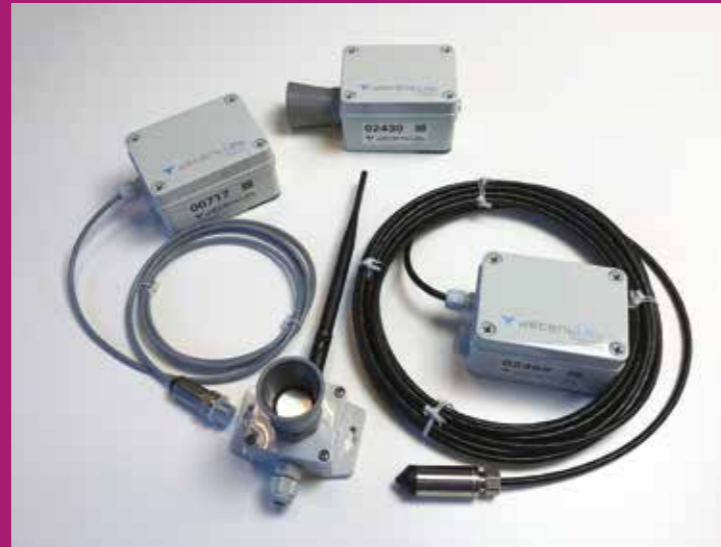
Kuvassa LoRaWAN-antureita, joita käytetään vesihuollon infran IoT-ratkaisuissa
